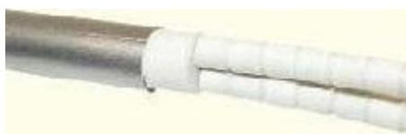
Connexion par 2 fils (âme souple en nickel, isolement soie de verre siliconée), protégés par des perles en céramique quand la température sur ceux-ci dépasse 350°C.
